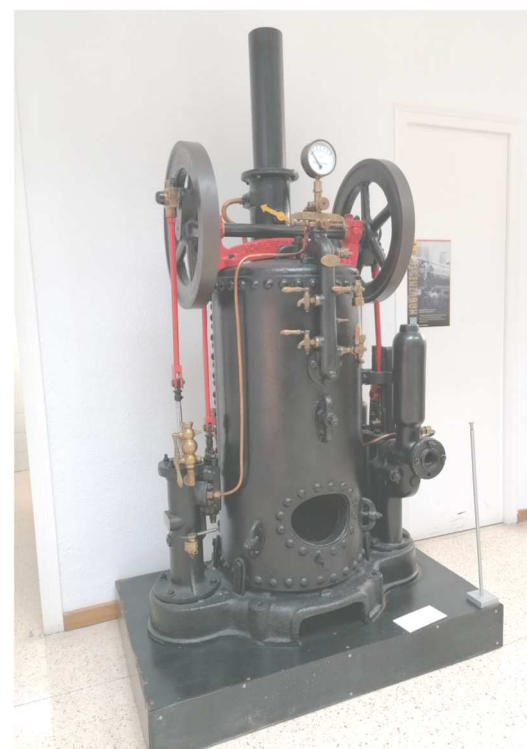
Une chaudière verticale «Pompe Faivre», construite à Nantes, illustre les technologies anciennes utilisées pour produire de l'énergie.
