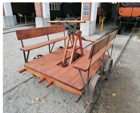
La «Zorilla» ou, en français, une draisine à bras, construite en bois, est une reconstitution intégrale.
